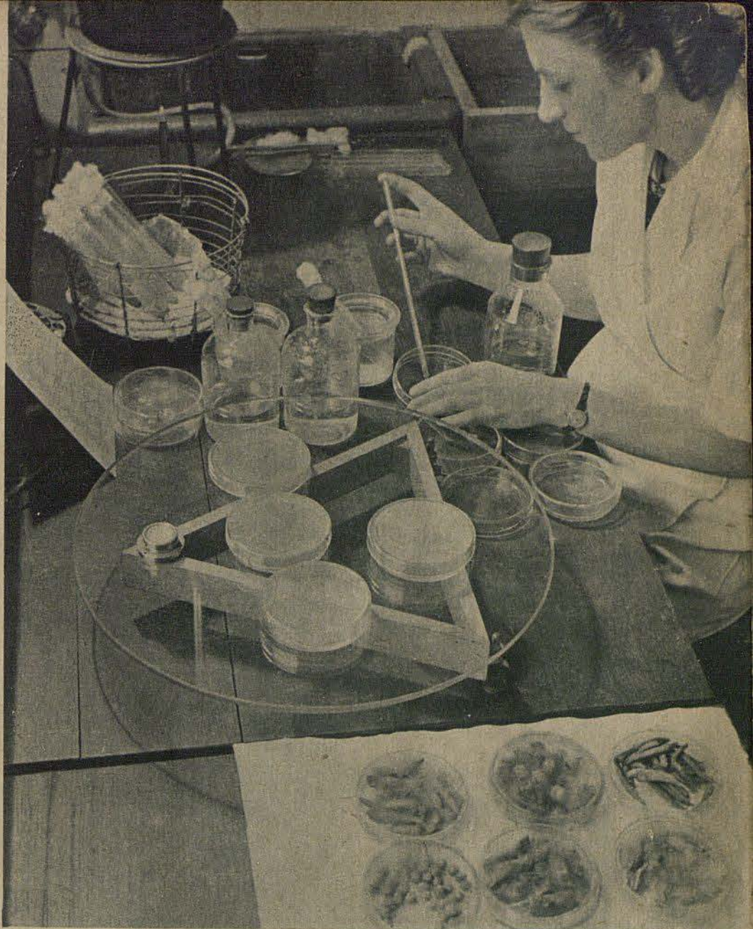
On compte les bactéries. On examine les légumes de conserve pour connaître leur contenu en bactéries. On dépose des échantillons sur un terrain de culture et on compte ensuite combien de germes sont restés vivants
