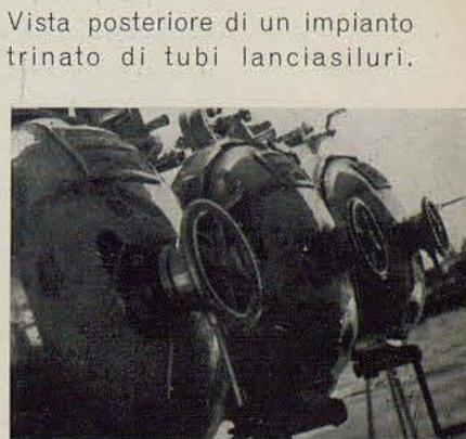
Vista posteriore di un impianto trinato di tubi lanciasiluri.
