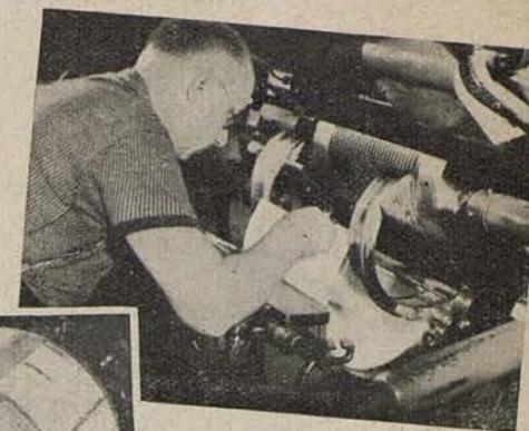
Las planchas en forma curva salidas de la fundidora son enfriadas por agua corriente y luego atornilladas sobre los cilindros de las rotativas.
