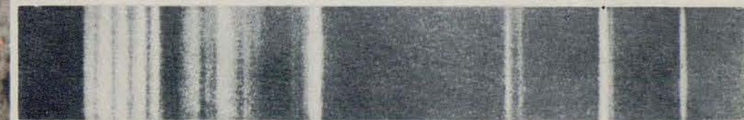
Спектр полярного сияния. Он содержит линии атомов и полосы молекул. В спектрах сияний зарегистрировано более 200 линий и полос. Большинство из них отождествлено с линиями уже известных веществ.
