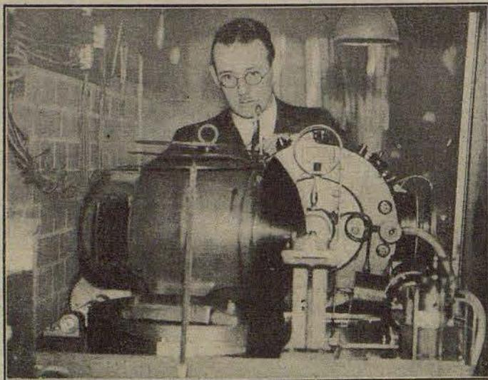
Ci sono fenomeni che si manifestano in una frazione di secondo. Un fulmine dura solo qualche centesimo di secondo, così il passaggio di un proiettile nell'aria. Per poter seguire attentamente i fenomeni ultra-rapidi è stata accoppiata una macchina cinematografica da presa con un motore elettrico molto veloce. Grazie a pellicole speciali, è stato possibile ottenere 60.000 fotografie in un solo minuto.
