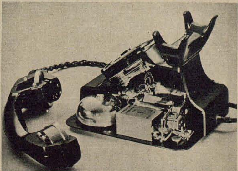
Coupe dans un appareil téléphonique moderne, système Siemens avec disque d'appel fonctionnant presque sans bruit et avec écouteur approprié à la forme de la tête
