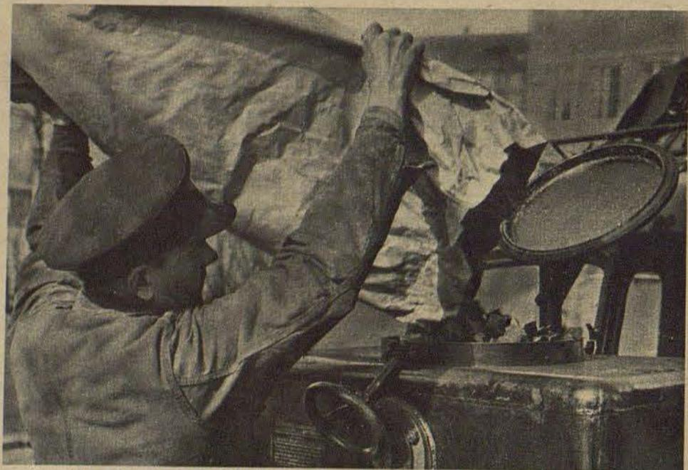
Le conducteur devient chauffeur car, avant le départ, il faut allumer le combustible. La plupart des générateurs contiennent 200 à 250 litres de charbon de bois; cette quantité de carburant permet de parcourir environ 150 kilomètres
