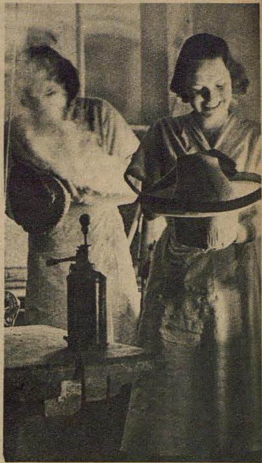
Sous un courant d'air chaud, dans une salle spéciale, les fournitures, soumises à la vapeur, sont allongées, étirées, mises en forme jusqu'à ce qu'elles deviennent souples et dociles dans les mains adroites des ouvrières
