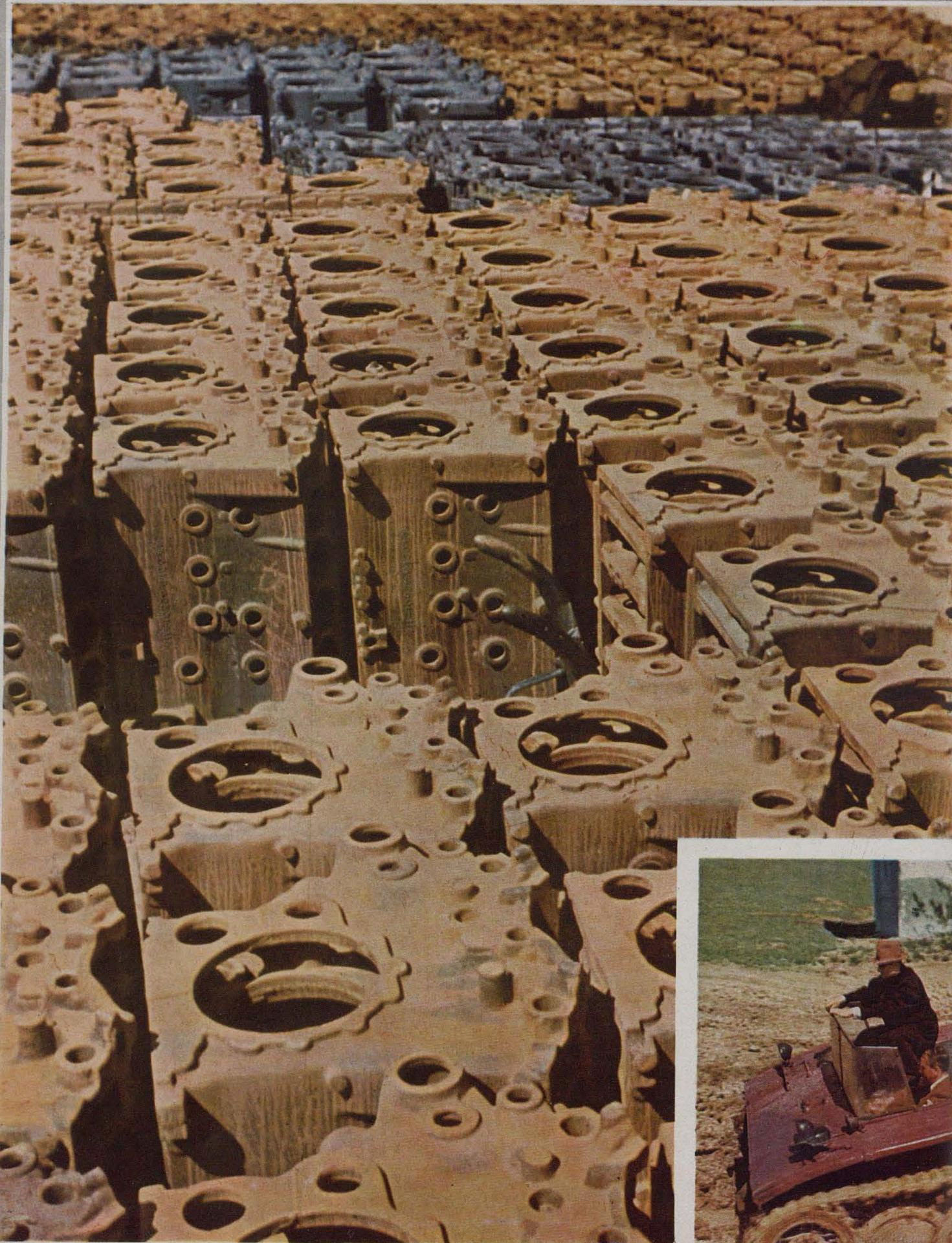
Les carters de moteurs en fon'e brute (photo de gauche) sont usinés à la chaîne dans la fabrique. On y adapte des moteurs de plusieurs centaines de chevaux. Avant de monter le moteur sur le char, on examine son rendement et sa résistance au banc d'essai (photo à droite). Ci-dessous: un nouveau modèle d'un char de reconnaissance est mis à l'essai et examiné par Speer, ministre du Reich, et par les constructeurs sur un terrain très accidenté. Clichés du correspondant de guerre Hanns Hubmann (PK)
