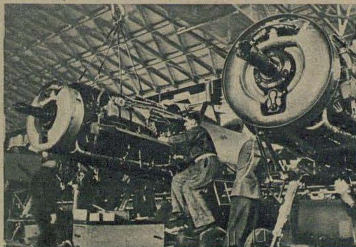
Les moteurs arrivent, apportés par une grue, toujours au même endroit. Quatre boulons d'acier fixent le moteur. La chaîne suit son cours. Cadence...
