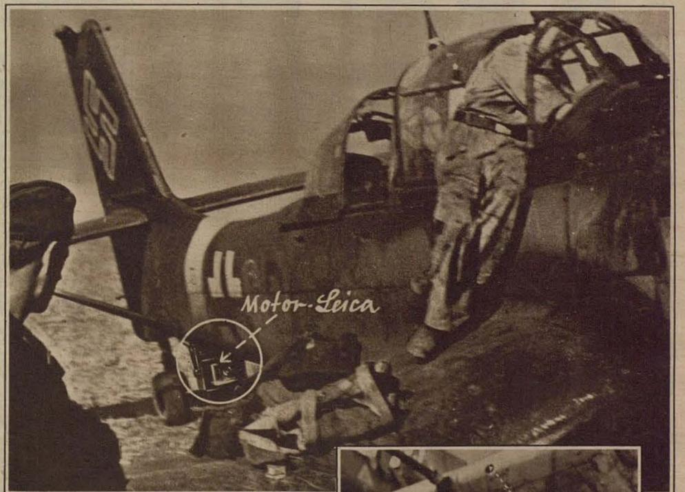
Motor-Leica an der Bauchseite des Flugzeugtruppes
