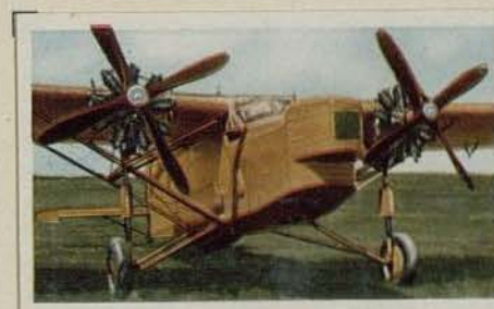
Italienischer Tagbomber „Caproni 102 BIB“. Motorleistung 2 \times 500 PS. Höchstgeschwindigkeit 245 km pro Std. Flugweite 1140 km. Bombenzuladung 450 kg
