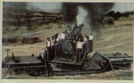
Amerikanisches schweres Eisenbahngeschütz im Feuer. Kaliber 34 cm. Geschützgewicht etwa 230 000 kg. Schußweite etwa 30 km
