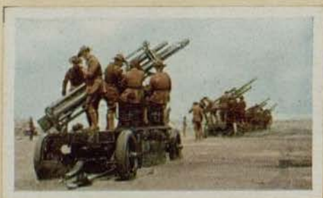
Amerikanische Flugabwehkanonen auf Lastwagen bei der Abwehr eines Flugangriffes. Kaliber 7,5 cm. Wirksame Schußhöhe 7000 m
