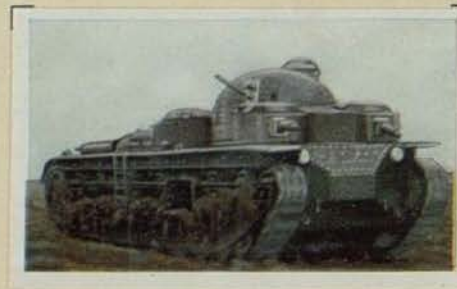
Größter englischer Vickers-Tank, Motorstärke 380 PS. Das Gesamtgewicht beträgt 32 t, die Höchstgeschwindigkeit 25 km pro Stunde. Besatzung 10 Mann.
