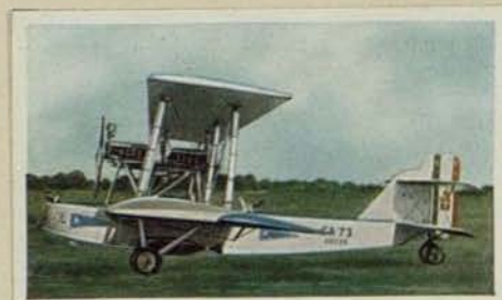
Italienischer Nachtbomber „Caproni 73ter“. Motorleistung 2 \times 500 PS. Höchstgeschwindigkeit 200 km pro Std. Flugweite 1000 km. Bombenlast 900 kg
