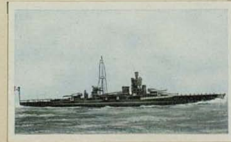
Italienischer Kreuzer „Gorizia“. Besatzung 830 Mann. Wasserverdrängung 10 000 t. Bestückung 8×30,3 cm und 16×10 cm Geschütze. Geschwindigkeit 32 sm
