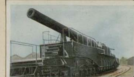
Französisches schweres Eisenbahngeschütz „H. M. 16“. Kaliber 52 cm. Geschützgewicht 275 000 kg. Schußweite 17 km
