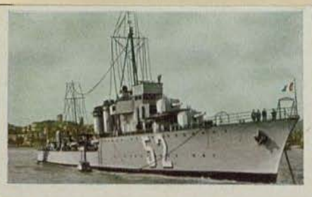
Französischer Zerstörer „Mistral“. Besatzung 153 Mann. Wasserverdrängung 1800 t. Bestückung 4 × 13 und 1 × 7,5 cm Kanonen. Geschwindigkeit 33,5 sm
