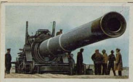
Amerikas größte Kanone für den Küstenschutz. Kaliber 42 cm. Rohrlänge 12 1/2 m. Schußweite über 30 km
