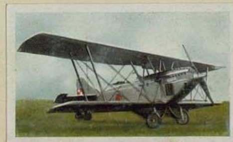
Polnischer Aufklärer „Lublin R 8“. Motorleistung 700 PS. Höchstgeschwindigkeit 230 km pro Std. Gipfelhöhe 6500 m. Flugweite 1500 km
