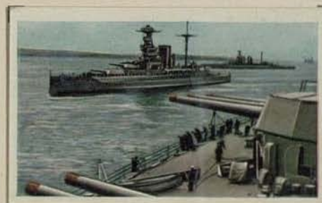
Englisches Linienschiff „Barham“. Besatzung 1234 Mann. Wasserverdrängung 33 000 t. Bestückung 8×38, 12×15,2 cm Kanonen und 4×10,2 cm Flak
