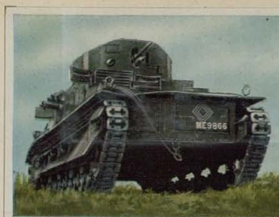
Englischer Medium-Vickers-Tank „Mk 2“. Besatzung 5 Mann. Bewaffnung 1 x 47 mm Kanone, 4 MG. Munitionsvorrat 90 Schuß 47 mm und 5000 MG-Schuß
