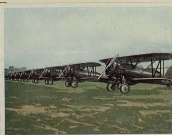
Amerikanischer Jagdflieger „Boeing P 12 E“. Motorleistung 550 PS. Höchstgeschwindigkeit 304 km pro Std. Erreichbare Höhe 7000 m
