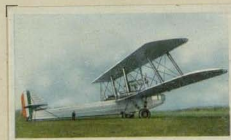
Größter italienischer Nachtbomber „Caproni 90 PB“. Das größte Bombenflugzeug der Welt. Motorleistung 6 \times 1000 PS. Höchstgeschwindigkeit 205 km pro Std. Flugweite 2000 km. Bombenlast 8000 kg
