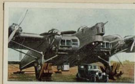
Größter französischer Nachtbomber „Dyle et Bacalan DB 20“. Motorleistung 4 \times 600 PS. Höchstgeschwindigkeit 210 km pro Std. Flugweite 1200 km. Bombenlast 2000 kg. Bewaffnung 9 bewegliche MG.
