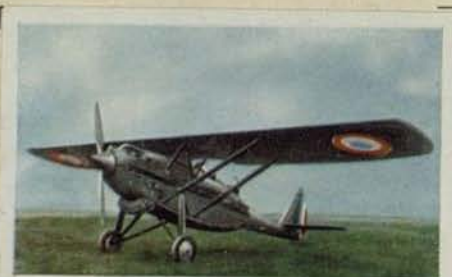
Französischer Aufklärer „Potez 39 A 2“. Motorleistung 650 P.S. Höchstgeschwindigkeit 240 km pro Std. Gipfelhöhe 8400 m. Flugweite 740 km
