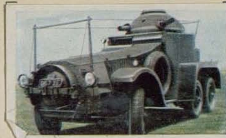
Englisch. Gup-Sechsrads-Straßenpanzer mit Funkanlage. Besatzung 5 Mann. Bewaffnung 2 Vickers-MG. Munition 6000 Schuß. Höchstgeschwindigkeit 50 km pro Stunde
