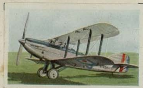
Englischer Aufklärer „Fairey 3 F“. Motorleistung 570 PS. Höchstgeschwindigkeit 260 km pro Std. Gipfelhöhe 7000 m. Flugweite 700 km
