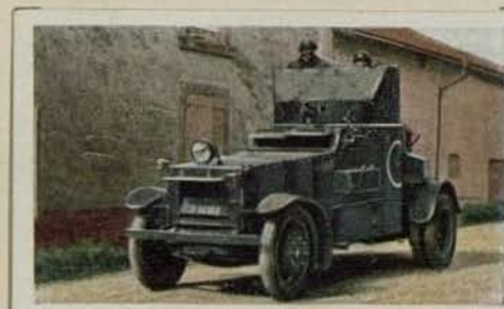
Französischer White-Straßenpanzer. Besatzung 4 Mann. Bewaffnung 1×37 mm halbautomatische Kanone und 1 Hotchkiss-MG. im Turm. Munition 198 Granatenpatronen und 5568 Schuß MG.
