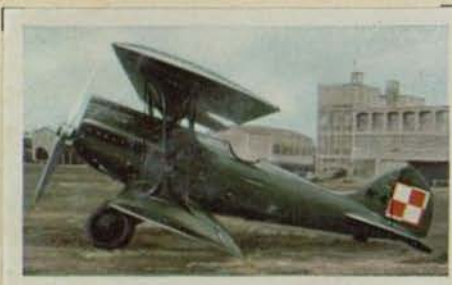
Polnischer Jagdeinsitzer „Blériot S61 C1“. Motor- leistung 450 PS. Höchstgeschwindigkeit 260 km pro Std. Gipfelhöhe 7500 m. Bewaffnung 2 MG.
