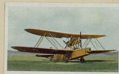
Italienischer Nachtbomber „Caproni 103 Bib“. Motorleistung 2 \times 750 PS. Höchstgeschwindigkeit 200 km pro Std. Flugweite 1000 km. Bombenlast 1000 kg
