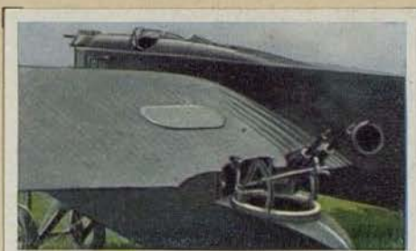
Linker Maschinengewehrstand des französischen Nachtbombers „Blériot 127“. Der MG.-Stand befindet sich in der Verlängerung der linken Seitenmotorengondel
