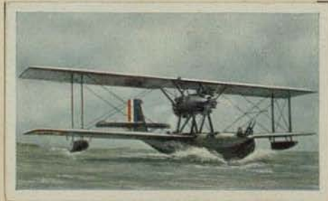
Französisches Patrouillenflugboot „Cams 51 R III“. Motorleistung 2 \times 450 PS. Höchstgeschwindigkeit 200 km. Flugweite 1000 km. Besatzung 5 Mann
