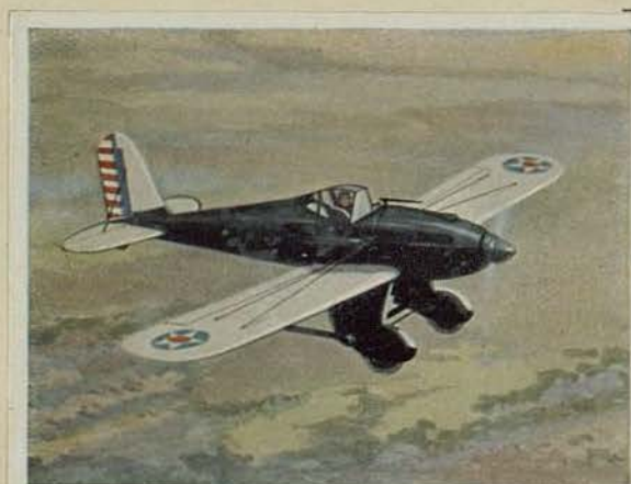
Amerikanischer Jagdflieger „Curtiss XP 93 A“. Motorleistung 640 PS. Höchstgeschwindigkeit 340 km pro Std. Gipfelhöhe 8000 m. Bewaffnung 2 starre MG.
