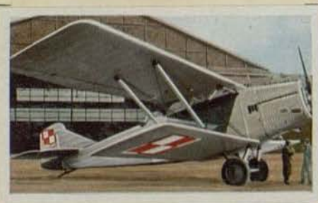
Polnischer Tagbomber „S.E.C.M. 120“. Motorleistung 600 PS. Höchstgeschwindigkeit 200 km pro Std. Flugweite 1000 km. Bombenzuladung 600 kg
