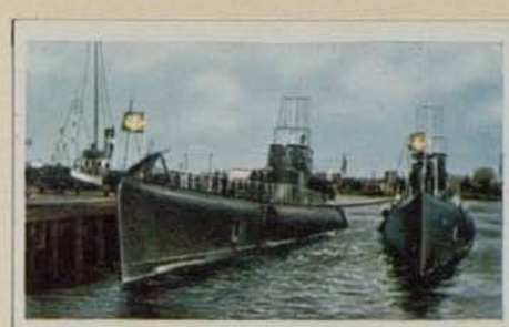
Italienische U-Boote der Klasse Balilla. Besatzung 80 Mann. Wasserverdrängung 1874 t. Bewaffnung 1 × 10 cm Kanone, 6 Torpedoausstößrohre
