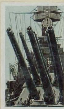
35,6 cm Langrohrgeschütze des amerikanischen Linienschiffes „Kalifornien“. Schußweite 35 km
