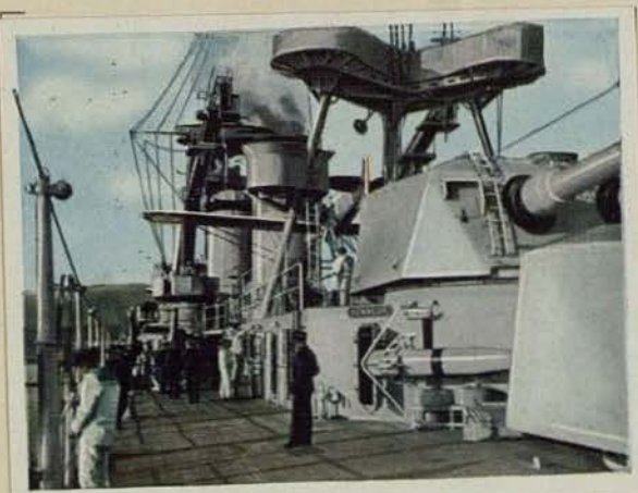
An Bord des französischen geschützten Kreuzers „Colbert“. Der Kreuzer besitzt außer Bestückung von 8×20,3 und 8×10 cm Kanonen eine Katapultanlage mit 2 Flugzeugen
