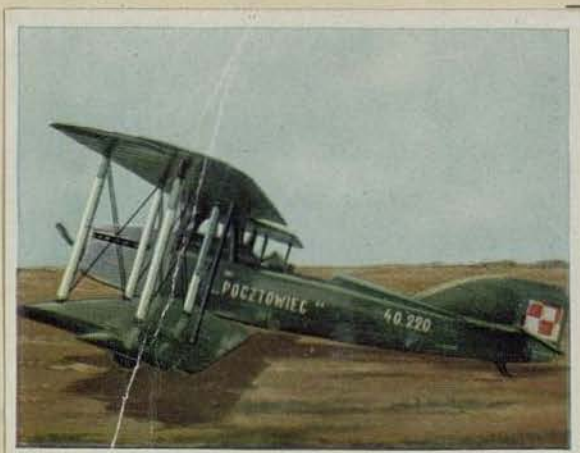
Polnischer Aufklärer „Potez 15 A 2“. Motorleistung 400 PS. Höchstgeschwindigkeit 210 km pro Std. Gipfelhöhe 6200 m. Flugweite 550 km
