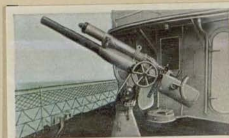
Flugzeugabwehrkanone von 7,5 Kaliber auf einem amerikanischen Zerstörer
