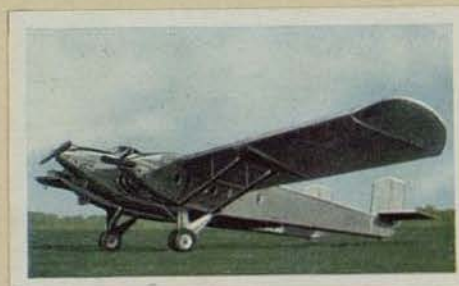
Französischer Truppentransporter „Dyle et Barclay DB 70“. Motorleistung 3×600 PS. Höchstgeschwindigkeit 190 km pro Stunde. Fassungsvermögen 28 Infanteristen
