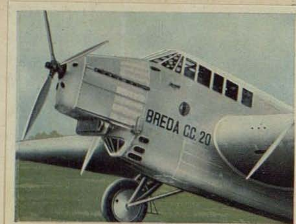
Italienischer Nachtbomber „Breda CC 20“ für Fernangriffe. Motorleistung 3 \times 50 PS. Höchstgeschwindigkeit 230 km pro Std. Flugweite 3000 km. Bombenlast 1500 kg. Bewaffnung 6 MG. u. 1 \times 20 mm MK.
