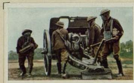
Englische schwere Haubitze in Feuerstellung. Kaliber 11,43 cm. Gewicht etwa 1360 kg. Schußweite 6,4 km
