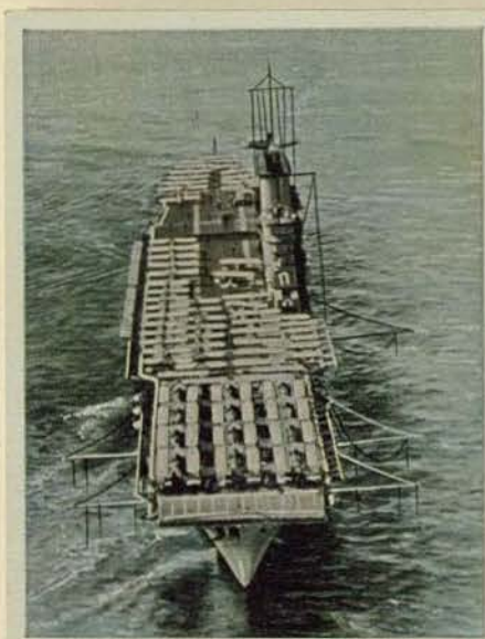
Amerikanisches Flugzeugmutterschiff „Saratoga“. Besatzung 1962 Mann. Wasserverdrängung 33 000 t. Fassungsvermögen 60 Flugzeuge
