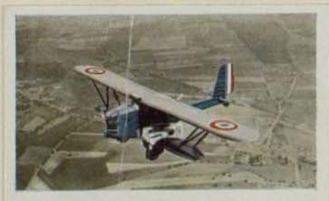
Französisches Mehrzweckflugzeug „Breguet 412“. Motorleistung 2 \times 700 PS. Höchstgeschwindigkeit 345 km pro Std. Flugweite 1000 km. Bombenzuladung 600 kg
