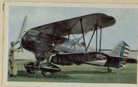
Amerikanischer Jagdflieger „Curtiss P 6 E“. Motorleistung 640 PS. Höchstgeschwindigkeit 310 km pro Std. Gipfelhöhe 6900 m. Bewaffnung 2 fest eingebaute MG.
