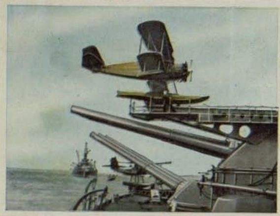
Katapultanlage des amerikanischen Linienschiffes „Kalifornien“. Die modernen amerikanischen Linienschiffe führen 2 Katapulte und 5 Bordflugzeuge mit sich
