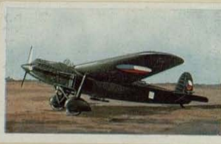
Tschechischer Tagbomber „Aero A 42“. Motorleistung 800 PS. Höchstgeschwindigkeit 270 km pro Std. Flugweite 1000 km. Bombenzuladung 960 kg
