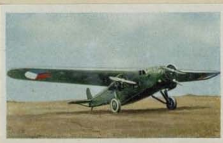
Tschechischer Nachtbomber „Avia BH 39“. Motorleistung 3 \times 500 PS. Höchstgeschwindigkeit 240 km pro Std. Flugweite 1500 km. Bombenlast 1200 kg
