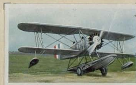
Amerikanisches Katapultflugzeug „Doughty O2U“. Motorleistung 425 PS. Höchstgeschwindigkeit 230 km pro Std. Gipfelhöhe 5600 m. Dient als Vordruckflugzeug für Kriegsschiffe
