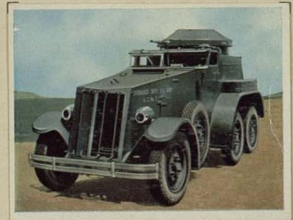
Amerikanischer Straßenpanzer mit Vierradantrieb und einem drehbaren Panzerturm. Bewaffnung 1 MG. und 1 MK. Munition 7200 Schuß. Geschwindigkeit 72 km pro Std.
