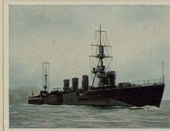
Japanischer Kreuzer „Tama“. Besatzung 440 Mann. Wasserverdrängung 5500 t. Bestückung 7 × 14 cm Kanonen. 2 × 8 cm Flak und 8 Torpedorohre. Geschwindigkeit 33 sm
