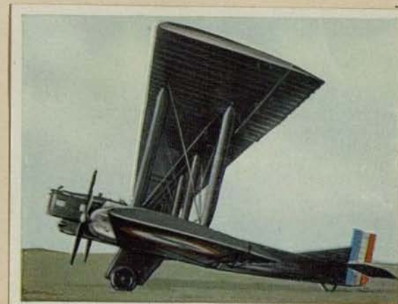
Französischer Nachtbomber „Farman F 160“. Motorleistung 2 \times 500 PS. Höchstgeschwindigkeit 190 km pro Std. Flugweite 1000 km. Bombenlast 2200 kg
