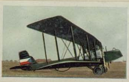
Tschechischer Nachtbomber „Aero A 24“. Motorleistung 2 \times 245 PS. Höchstgeschwindigkeit 160 km pro Std. Flugweite 600 km. Bombenlast 400 kg
