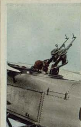
Englischer Aufklärer „Gloster Vespene“. Zur Verteidigung gegen Angriffe bedient sich der Beobachter eines nach allen Richtungen hin schwenkbaren Zwillingsmaschinen-gewehres
