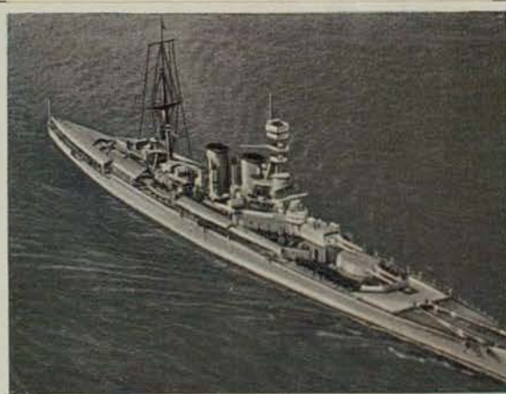
Englisches Schlachtkreuzer „Xenophon“. Besatzung 1300 Mann. Wasserverdrängung 37 400 t. Bestückung 6×38,1, 15×10,2 cm Kanonen und 4×10,2 cm Flak
