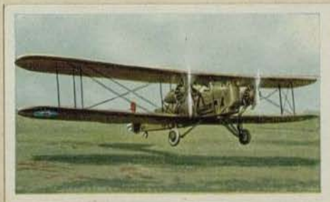
Amerikanischer Nachtbomber „Keystone B.S.A.“. Motorleistung 550 PS. Höchstgeschwindigkeit 200 km pro Std. Flugweite 1000 km. Bombenzuladung 1100 kg
