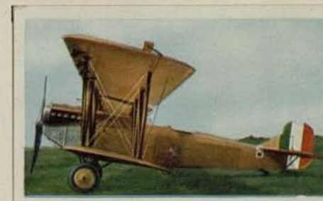
Italienischer Tagbomber „Fiat BR III“. Motorleistung 970 PS. Höchstgeschwindigkeit 230 km pro Std. Flugweite 850 km. Bombenzuladung 500 kg
