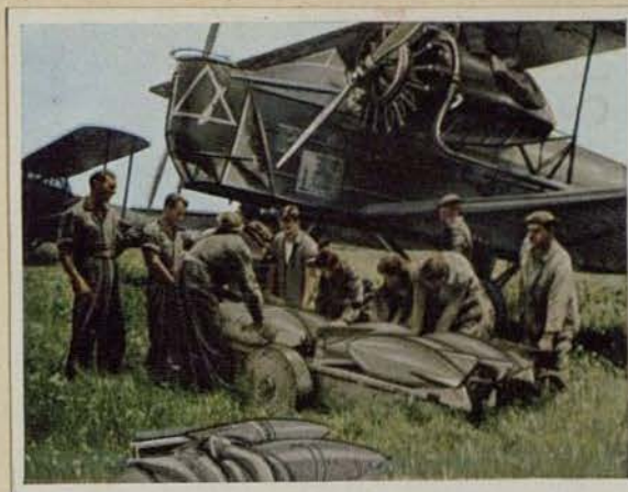
Amerikanische Nachtbomber werden mit Bomben beladen. Die todbringende Last wird schichtweise in Magazinen aufgehängt und gelagert
