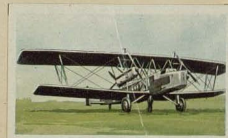
Größter englischer Nachtbomber „Vickers 163“. Motorleistung 4 \times 560 PS. Höchstgeschwindigkeit 220 km pro Std. Flugweite 2000 km. Bombenladung 2000 kg
