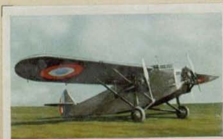
Französisches Kolonialflugzeug „Potez 402“. Motorleistung 3 \times 300 PS. Höchstgeschwindigkeit 230 km pro Std. Flugweite 1300 km. Militärische Last 900 kg
