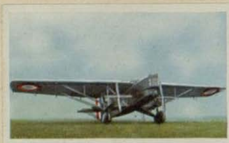
Französischer Nachtbomber „Farman F 211“. Motorleistung 4 \times 230 PS. Höchstgeschwindigkeit 195 km pro Std. Flugweite 1500 km. Bombenladung 1900 kg
