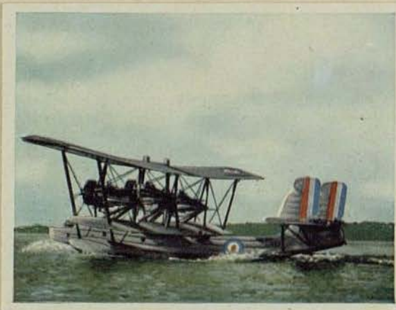
Englisches Patrouillenboot „Supermarine Southampton 10“. Motorleistung 3 \times 550 PS. Höchstgeschwindigkeit 220 km pro Std. Flugweite 1500 km. Bombenzuladung 1600 kg
