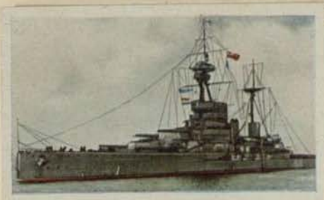
Englisches Linienschiff „Rodney“. Besatzung 1300 Mann. Wasserverdrängung 40 000 t. Bestückung 9×40,6 und 12×15,2 cm Kanonen. Geschwindigkeit 23 sm
