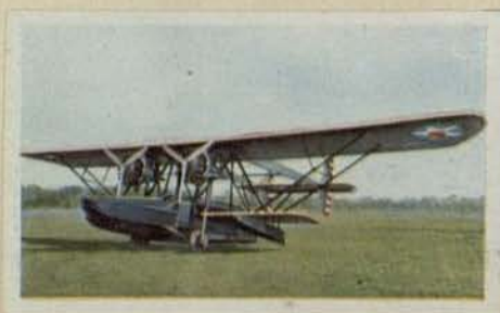
Amerikanisches Patrouillenboot „Sikorsky C6a“. Motorleistung 2 \times 410 PS. Höchstgeschwindigkeit 200 km pro Std. Flugweite 1200 km. Militär. Zuladung 1000 kg
