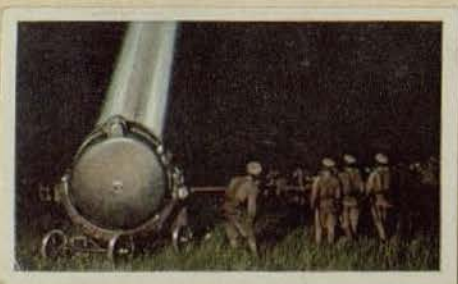
Japanischer Scheinwerfer zur Beleuchtung angreifender Flugzeuge während der Nacht, zur Unterstützung der Flugabwehr
