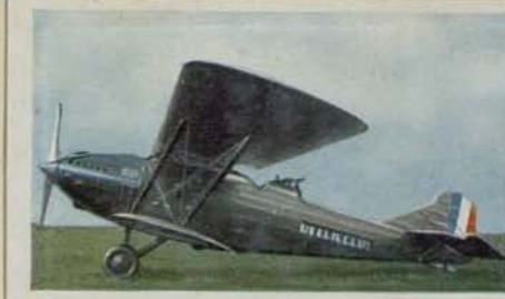
Französisches Tagbombenflugzeug „S. E. C. M. 122 BP“. Motorleistung 650 PS. Höchstgeschwindigkeit 220 km pro Std. Flugweite 1000 km. Bombenzuladung 400 kg
