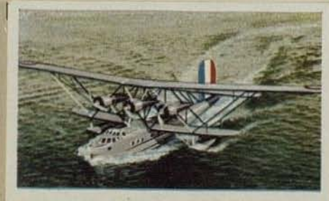
Französisches Patrouillenflugboot „Breguet Bizerte“. Motorleistung 3 \times 850 PS. Höchstgeschwindigkeit 250 km pro Std. Flugweite 1800 km. Bombenlast 1000 kg
