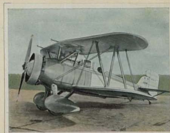
Amerikanischer Aufklärer „Curtiss Helldiver O2C2“. Motorleistung 650 PS. Höchstgeschwindigkeit 286 km pro Std. Gipfelhöhe 5700 m. Flugweite 600 km
