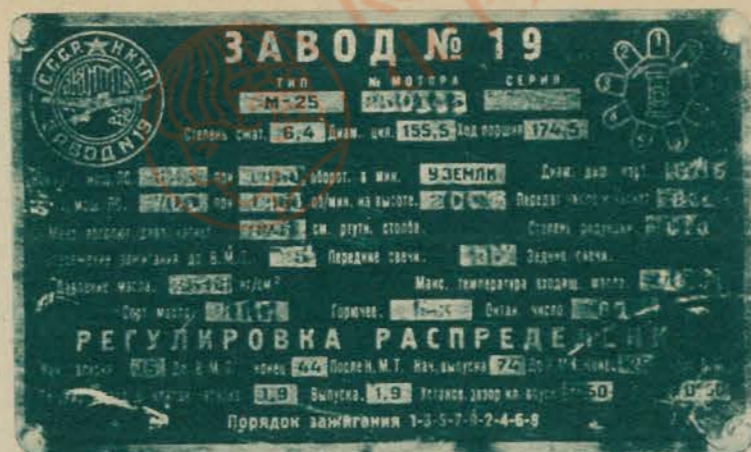
Armaturenschild des Flugzeuges sowjetischer Herkunft, geflogen von Sergius Viktorowitsch Piontkowsky: „Fabrik-No. 19. SSSR. – IKTP. – Typ M-25. Motorennummer 250145“.
