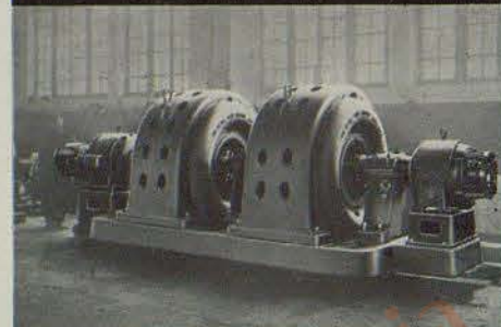
Gruppo convertitore di frequenza. 1100 KVA - 5000 Volte.
