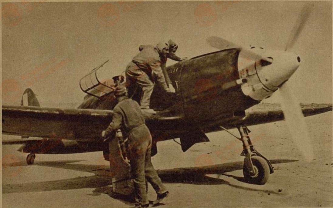
Si provano i motori del Macchi 202
