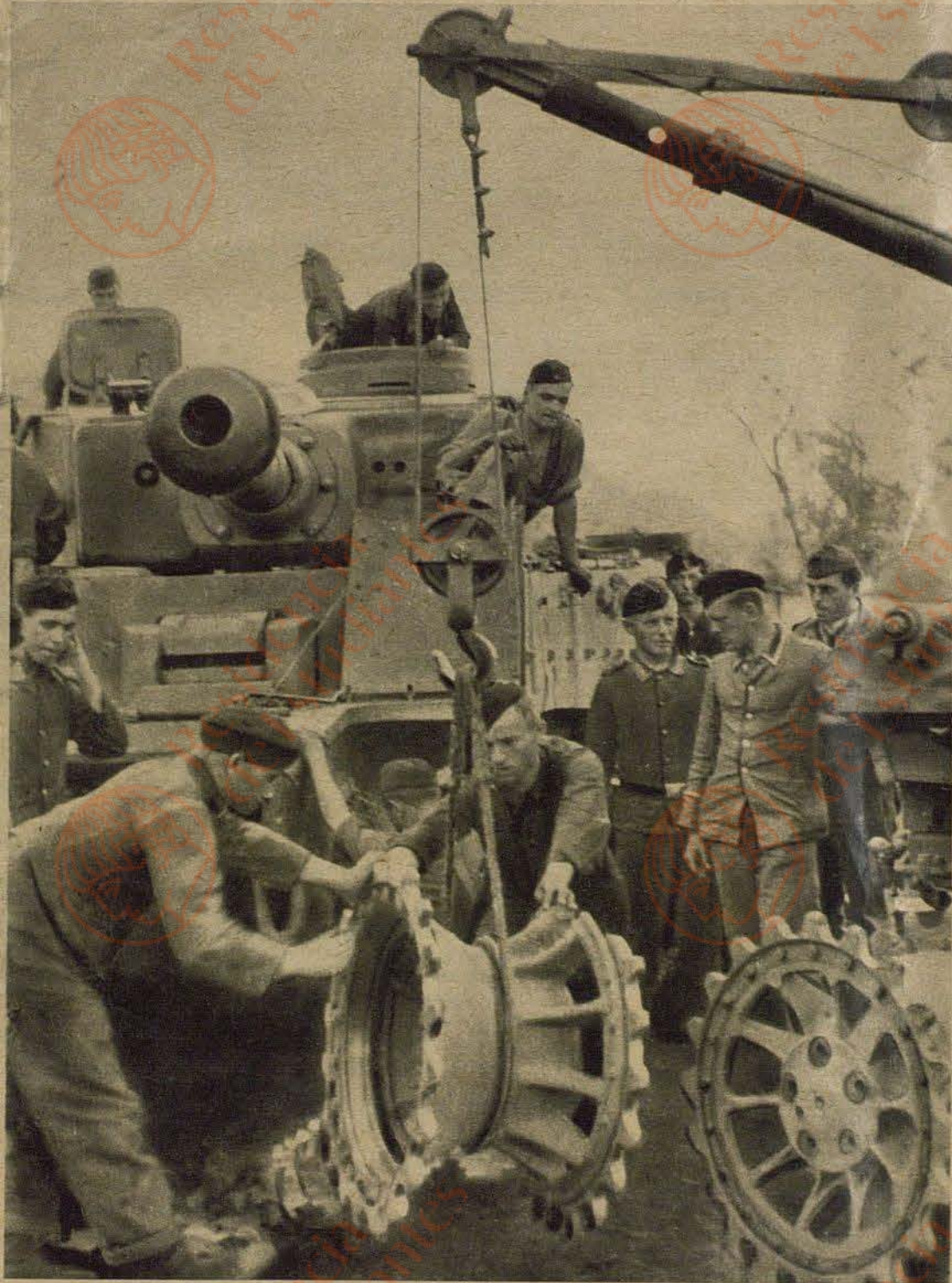
Mit Hilfe eines Kranwagens wird das beschädigte Treibrad gegen ein neues ausgetauscht
