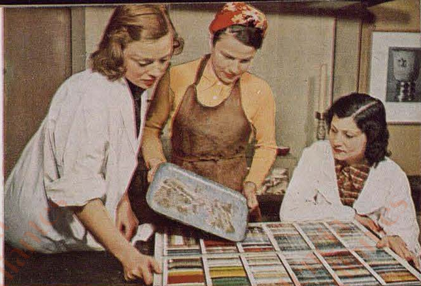
Le choix des couleurs se fait sur de petits échantillons déjà passés au four, car le verre pilé change de couleur au four
