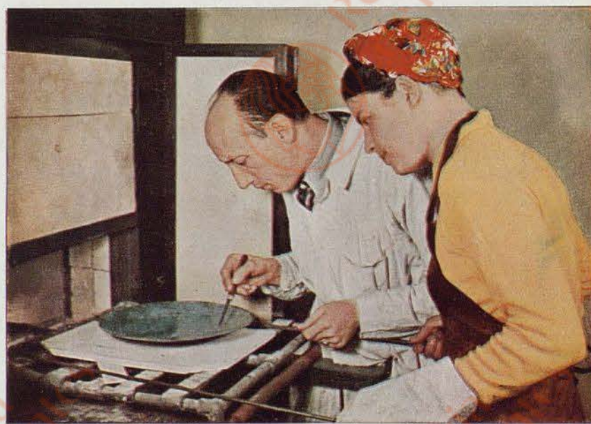
Une coupe prête pour l'émaillage est soumise à un dernier examen avant d'être introduite dans le four spécial où, soumis à des températures de 700 à 900 degrés, l'émail sortira durci et tel que le montre le cloisonné ci-dessous
