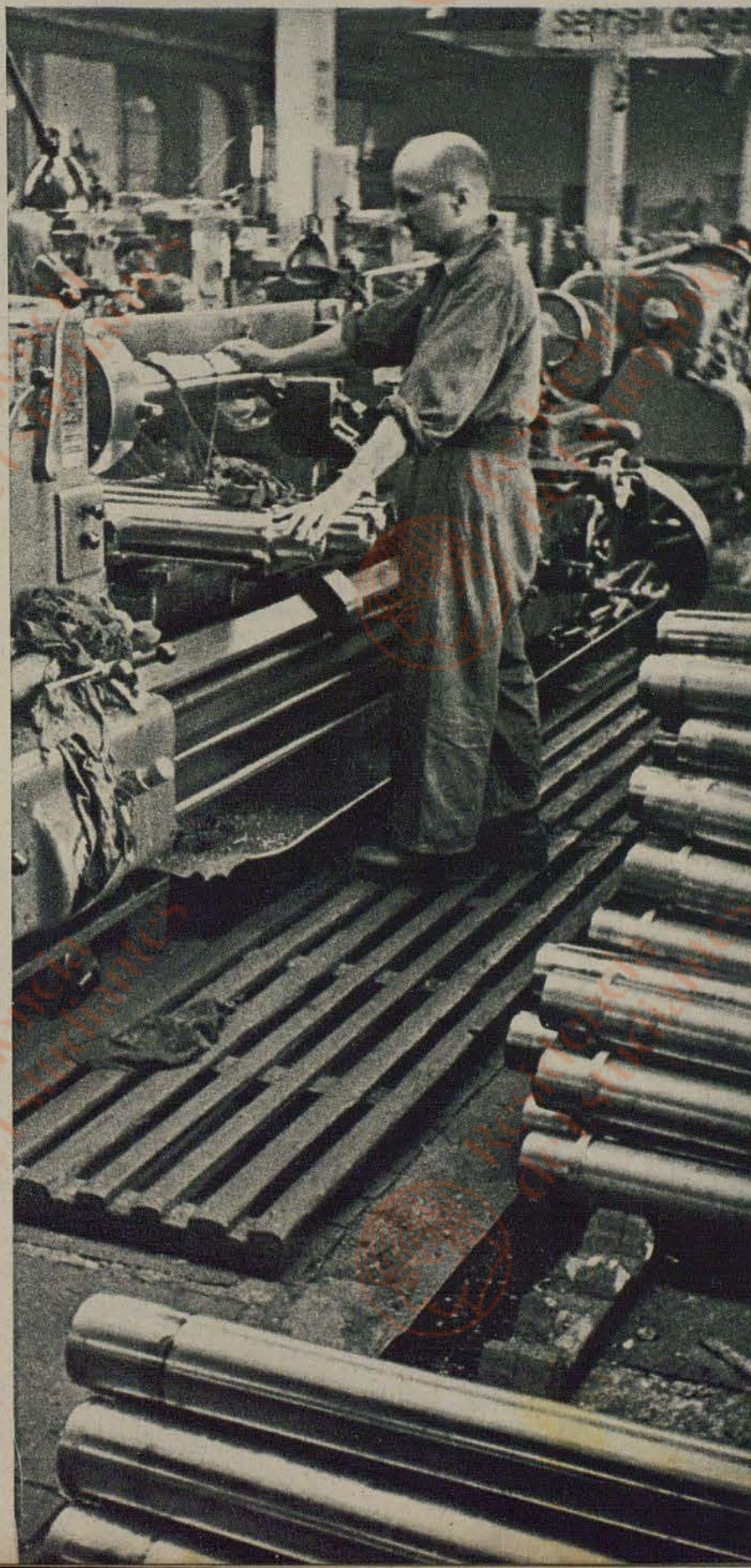
Lance-grenades marin. Les tubes de l'appareil lanceur sont tournés.
