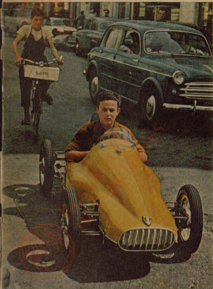
EL CISITALIA que costó $1.700 tiene un motor de gasolina de 3\frac{1}{2} HP, y llegó a 61 Km/h. en una carrera.
