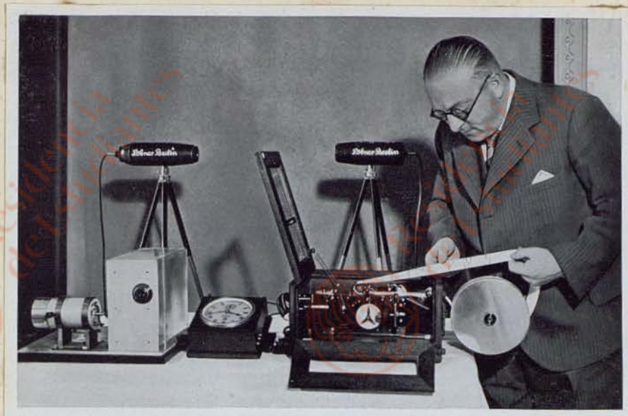
Filmaufnahme-Apparat, Präzisionsuhr und Registrier-Chronograph für die neue Zielphotographie.
