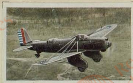
Amerikanischer Jagdweisiger „Curtiss A 8“. Motorlei- stung 650 PS. Höchstgeschwindigkeit 350 km pro Std. Gipfelhöhe 9000 m. Bewaffnung 4 starre und 1 bewegliches MG.
