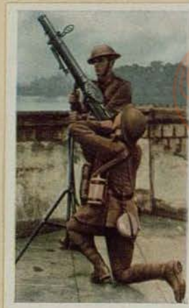
Englisches leichtes MG. in Feuerstellung gegen Fliegerangriffe. Die Munitionstrommel hat 50 Schuß
