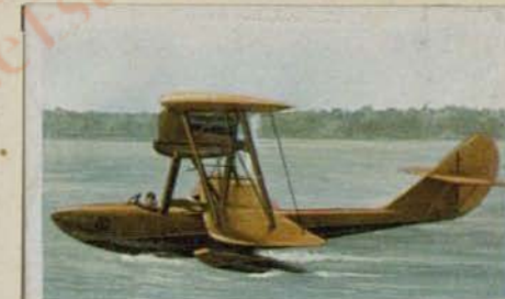
Italienisches Jagdflugboot „Savoia S 58“. Motorleistung 400 PS. Höchstgeschwindigkeit 280 km. Gipfelhöhe 6000 m. Bewaffnung 2 festeingebaute MG.
