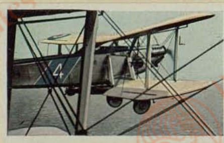
Englischer Torpedoträger „Blackburn Ripon 2“. Motorleistung 530 PS. Höchstgeschwindigkeit 200 km pro Stunde. Bombenlast 1 Torpedo von 750 kg
