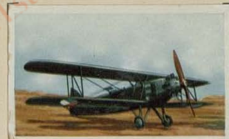
Tschechischer Aufklärer „Letov S 216“. Motorleistung 480 PS. Höchstgeschwindigkeit 230 km pro Std. Gipfelhöhe 7000 m. Flugweite 600 km
