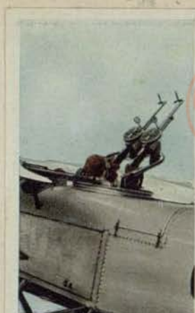
Englischer Aufklärer „Vespene“. Zur Verteidigung gegen Angriffe bedient sich der Beobachter eines nach allen Richtungen hin schwenkbaren Zwillingsmaschinen-gewehres
