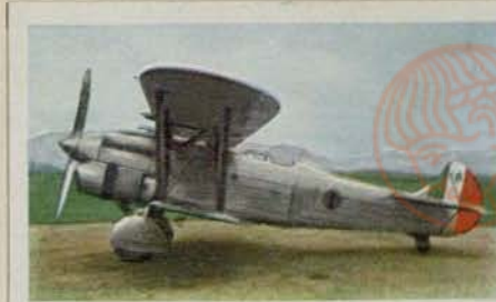
Italienischer Jagdeinsitzer „Fiat CR 30“. Motorleistung 800 PS. Höchstgeschwindigkeit 360 km pro Std. Gipfelhöhe 9 000 m. Bewaffnung 2 starre MG.
