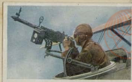
Amerikanisches Beobachter-Maschinengewehr auf einem drehbaren Maschinengewehrtraher befestigt, das zur Verteidigung gegen Angriffe nach allen Richtungen hin geschwenkt werden kann
