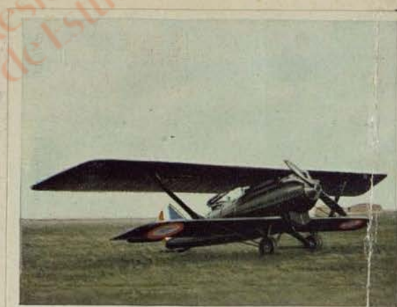
Französischer Aufklärer „Breguet 19“. Motorleistung 450 PS. Höchstgeschwindigkeit 220 km pro Std. Gipfelhöhe 7200 m. Flugweite 600 km
