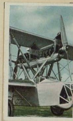
Italienischer Nachtbomber „Caproni 101 Bib“. Motorleistung 2 x 500 P.S. Höchstgeschwindigkeit 245 km pro Std. Flugweite 1100 km. Bombenlast 500 kg
