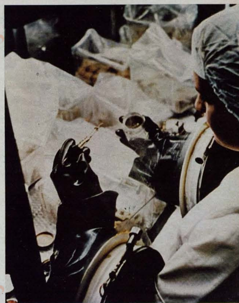
Arriba: las grandes «manos» de goma mediante las cuales los técnicos del laboratorio de Houston manipularán las muestras lunares. A la izquierda: un grupo de ratones a los que se inyectarán pequeñas dosis de muestras lunares para verificar los efectos de una eventual contaminación. Los ratones serán mantenidos bajo severo control hasta la cuarta generación
