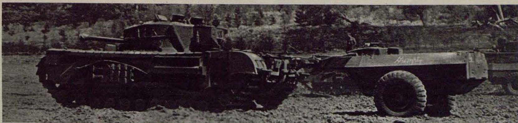
Arriba: El "Crocodile" es el modelo de mayor tamaño del lanzallamas. Va montado en un tanque "Churchill" y lleva el combustible en un remolque blindado. Sigue actuando el tanque "Churchill" corriente, que ahora puede, por añadidura, vomitar fuego a la distancia de más de 135 metros.
